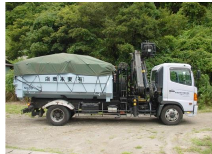
④コンテナ装着・飛散養生、処分場へ
